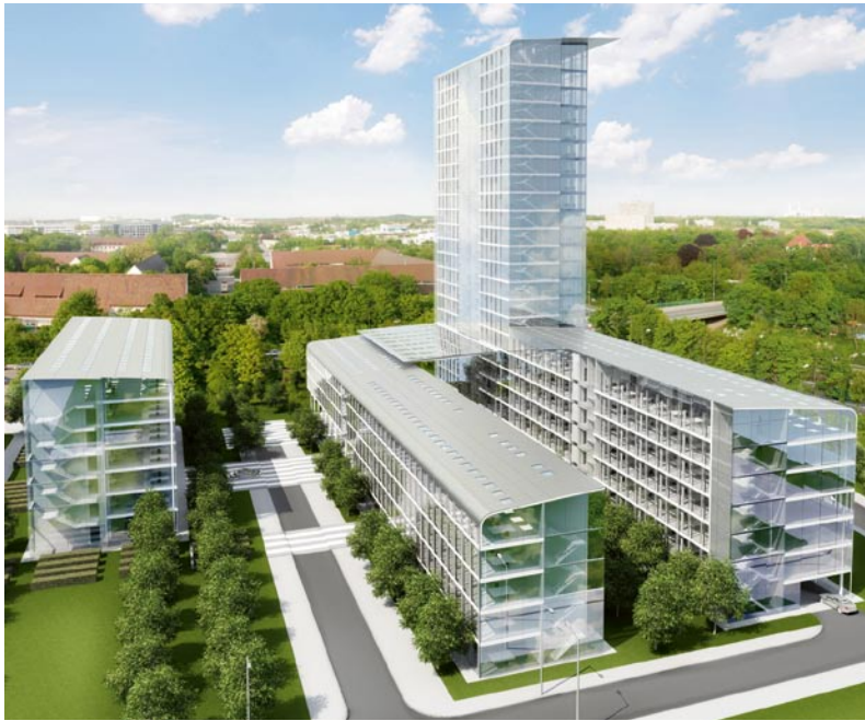
Der 84 m hohe „Skyline Tower“ München ist das bisher größte Projekt mit thermischer Bauteilaktivierung über das Lüftungssystem (Computerbild © BBIG)
